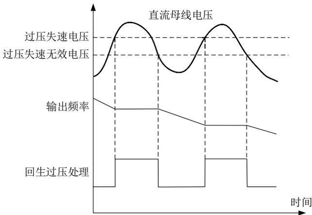
图 7-23 过压失速保护示意图
