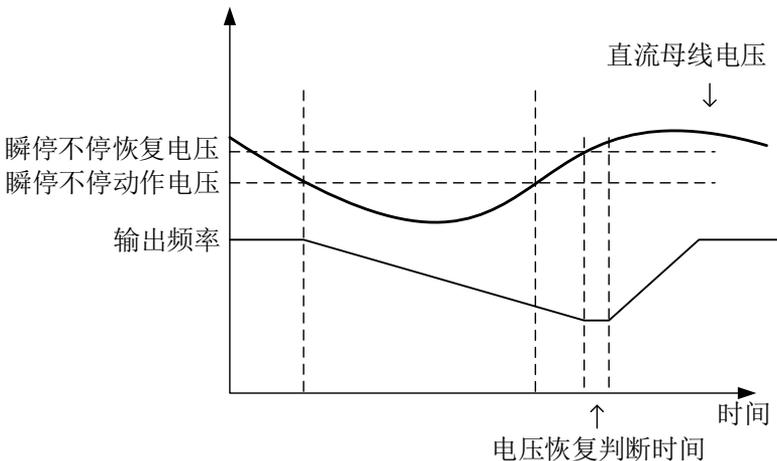
图 7-24 瞬停不停减速功能动作示意图
