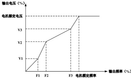
图 7-19 多点折线 V/F 曲线示意图
