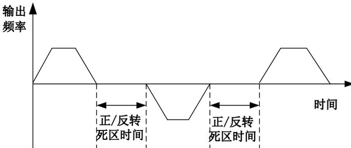
图 7-10 正/反转死区时间示意图
