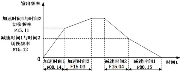
图 7-34 加减速时间自动示意图
