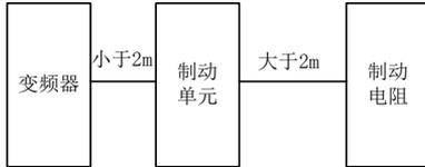
图 4-19 导线的长度
