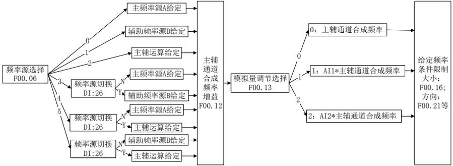
图 1-1 速度输入方式示意图
