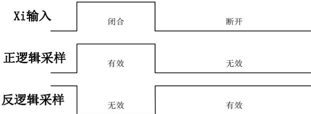
图 7-12 端子正反逻辑采样示意图
