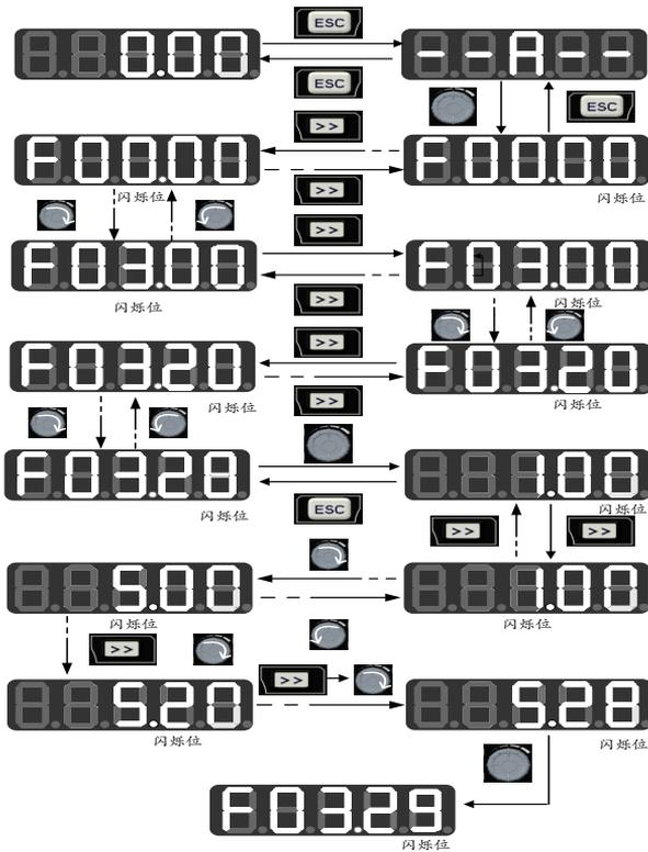
图 4-3 从上电至设置 F03.28=5.28 的操作流程图
