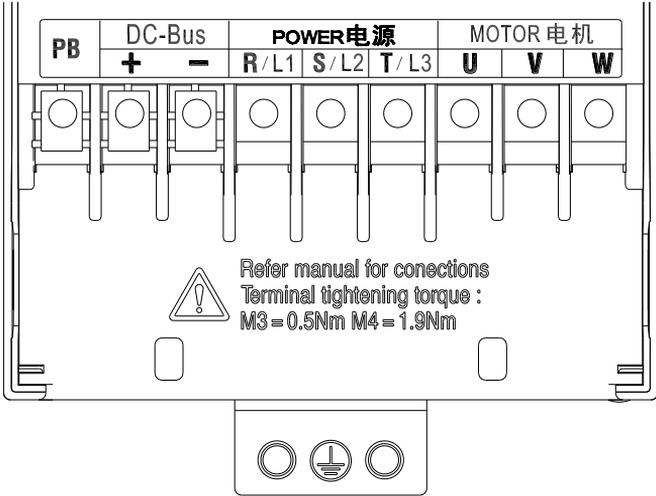
b) 380V 2.2kw~4.0kw 端子示意图
