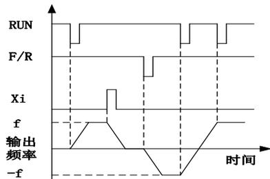
(a) F00.03=2 三线控制接线示意图
