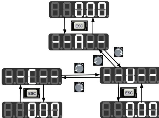
图 4-2 菜单模式选择操作流程图
