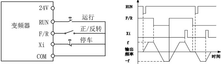
(c) F00.03=3 三线控制接线示意图 (d) F04.19=0, F00.03=3 正/反转运行逻辑
