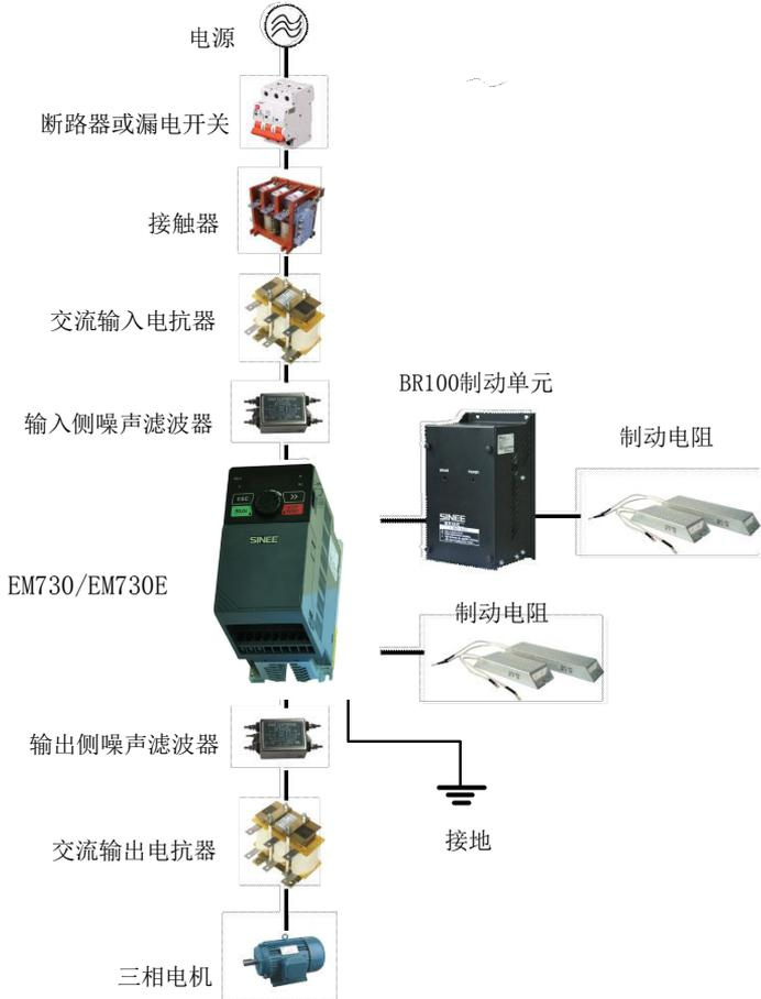
图 3- 1 变频器与外围设备的连接图
