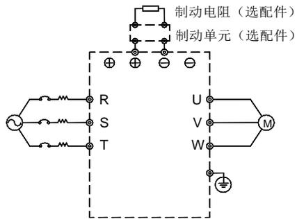
图 3-3 主回路标准接线
