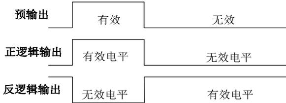
图 7-14 数字输出端子正反逻辑输出示意图
