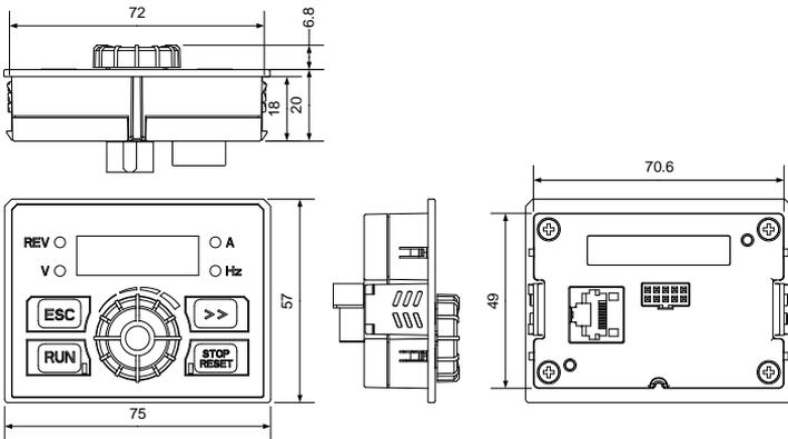
图 2-1 EM730/EM730E 系列变频器和键盘外形尺寸图
