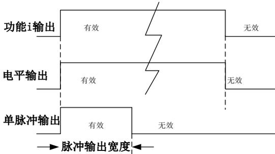
图 7-13 数字输出端子电平和单脉冲输出示意图
