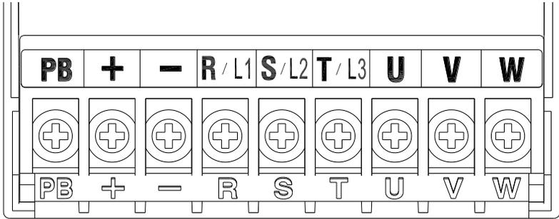
a) 380V 0.75kw~1.5kw 端子示意图
